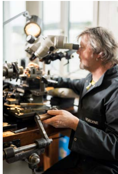
Guillochage main d'un cadran
