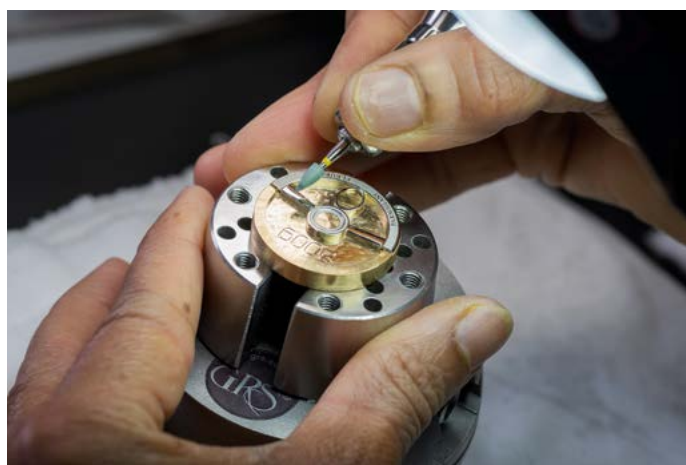
Anglage main d'une masse en platine
